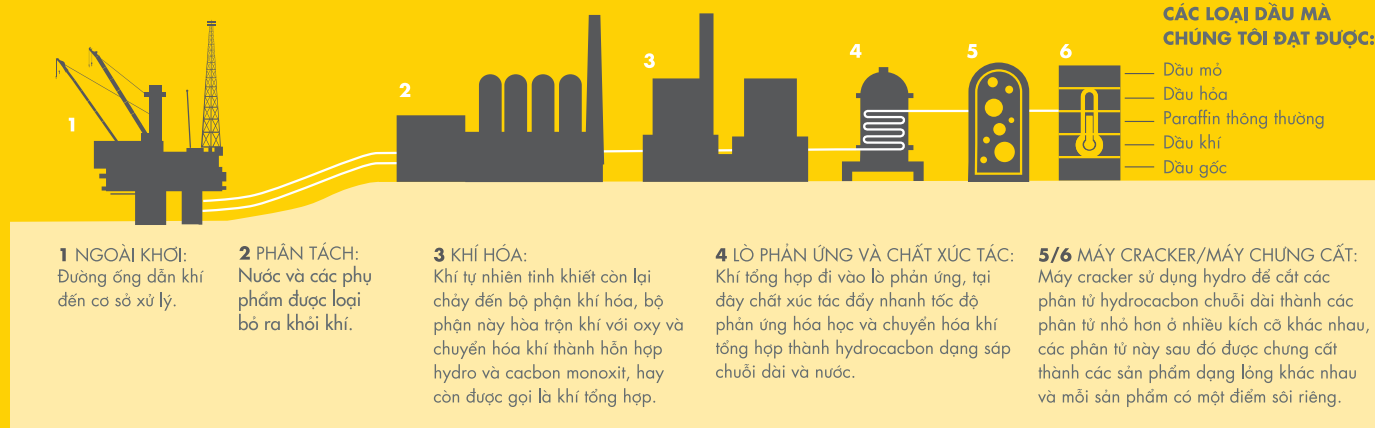
Hình 2: Quy trình GTL chuyển hóa khí tự nhiên cháy sạch thành nhiên liệu sạch và dầu gốc chất lượng cao thông qua quy trình Fischer-Tropsch.
